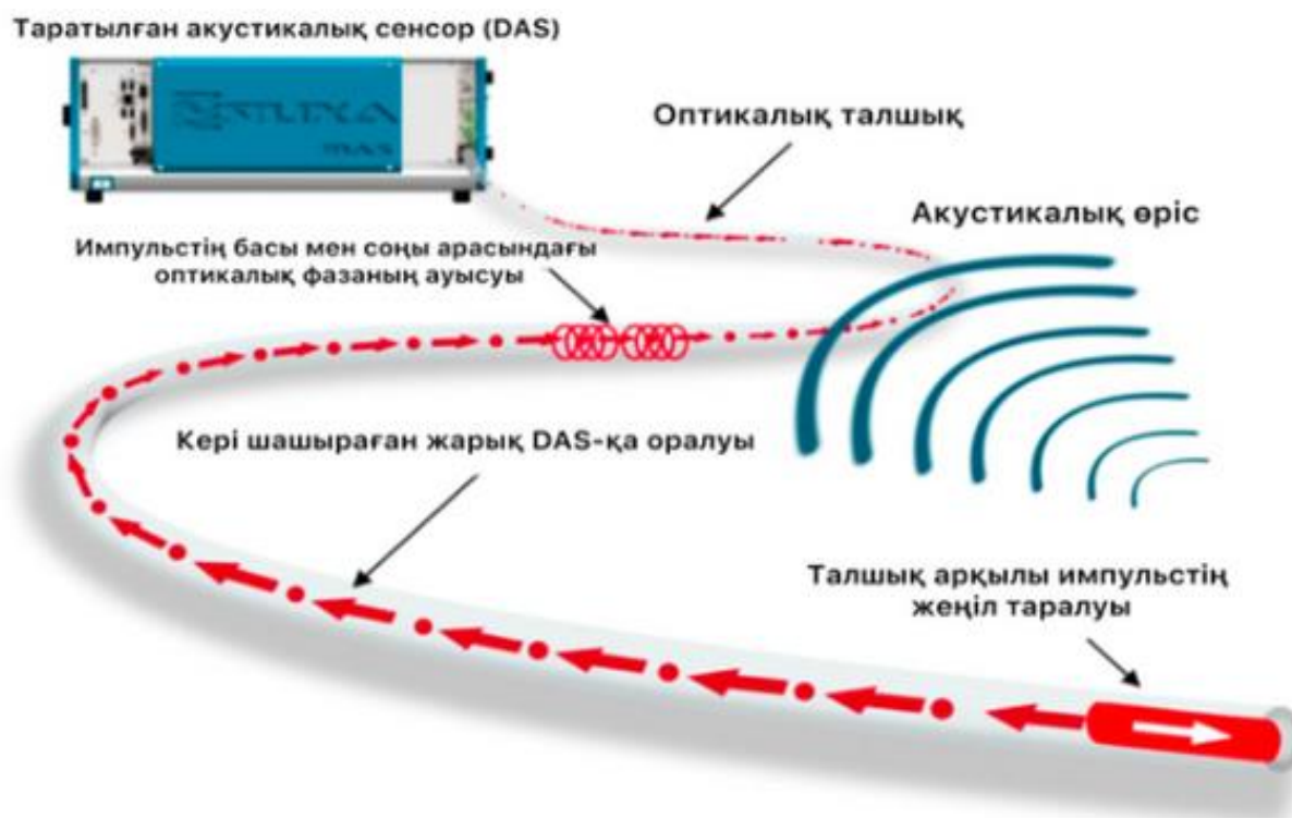
1.2 - сурет – DAS (Distributed Acoustic Sensing) технологиясының жұмыс істеу принципі
